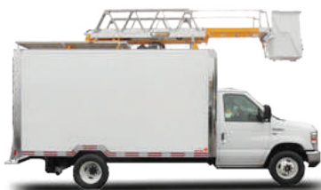
Cube nacelle 13 pieds à échelle isolée 39 pieds Insulated 39' telescopic aerials ladder cube trucks
